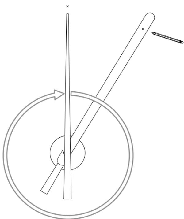
Para marcar el siguiente punto, gire manualmente 360° la minutera, y la horaria se situará automáticamente en la posición del siguiente punto. Repetir esta operación hasta completar las doce señales.
