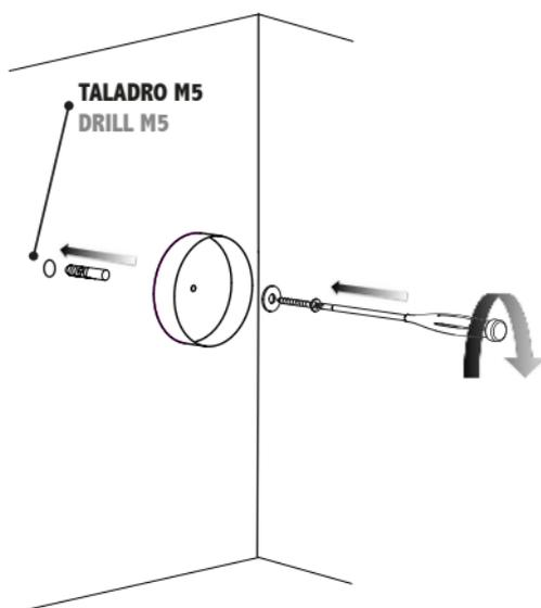
Dependiendo del tipo de superficie, la cajacentral del reloj podrá ser atornillada a la pared, o mediante el adhesivo incluido, pegada a la pared.
