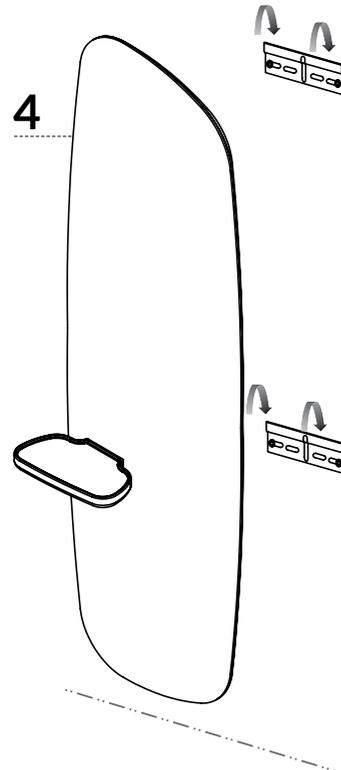
Una vez montada la fijación, colgar la balda mediante los ganchos que tiene en la parte posterior.
